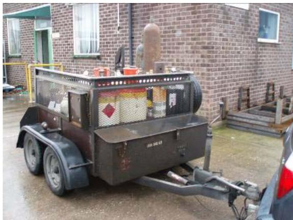
o un veicolo predisposto per il trasporto di gas (avente un divisorio a tenuta stagna che separi il conducente dal carico e garantisca un'adeguata aerazione)
