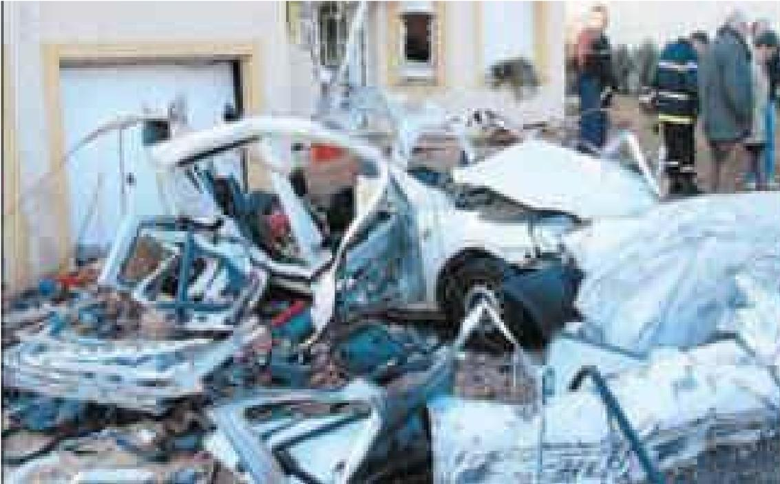
**Una vettura chiusa che conteneva una bombola di gas combustibile è andata completamente distrutta all'apertura delle portiere, probabilmente a causa di una perdita e di una scintilla.**
